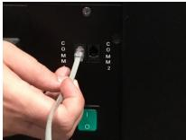
A. Unit wordt geleverd met 50 voet (15 meter) kabel met RJ-9 type verbinding samen met de Remote User Interface Controller.
