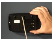
F. Boor twee 3 mm gaten en steek ankers in het montageoppervlak. Ankers zijn mogelijk niet nodig als ze vastzetten aan wandnooten of rekken. Steek schroeven in de ankers en test passen de installatie van de achterplaat. Draai/los schroeven om een knusse pasvorm te creëren.
