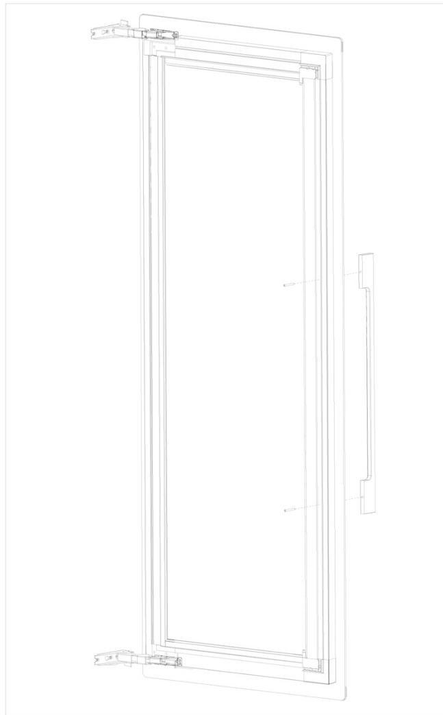
Hvis skruerne huller i håndtaget ikke passer perfekt med hullerne i døren, skal du bruge en boremaskine til at bore hullerne i døren en smule større (i overfladen side).
