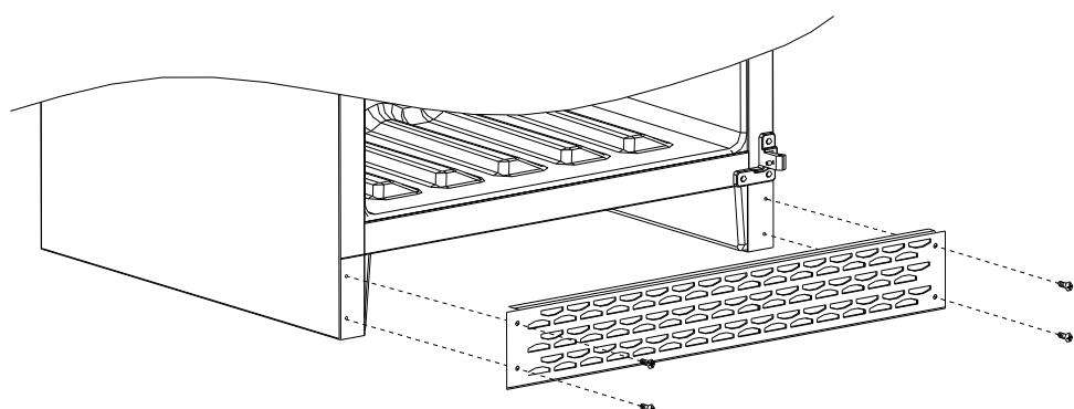
1. Das Lüftungsgitter und die 4 4" 12-Schrauben aus dem Beutel nehmen.
