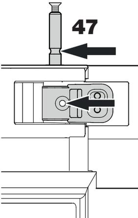
47. Lagerbolzen so weit einschieben, bis die Nut des Bolzens in einer Linie mit der Bohrung des Scharnierwinkels ist.
