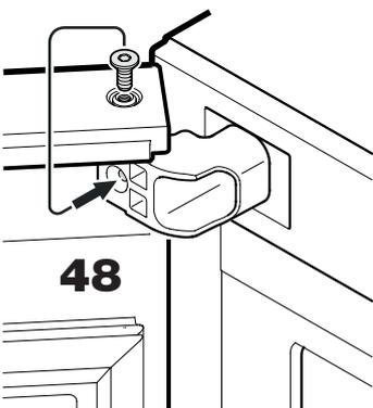
48. Schraube vom Lagerbolzen herausdrehen und in die Bohrung des Scharnierwinkels eindrehen.
