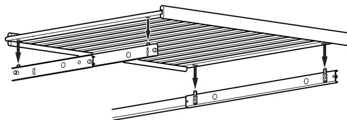
Auszugschienen bis zum Anschlag herausziehen.
