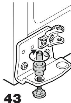
43. Stellfuß von unten einsetzen und Bolzen aufschrauben.
