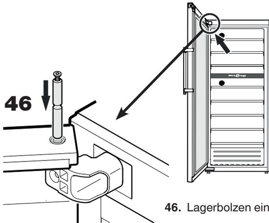
46. Lagerbolzen einsetzen.
