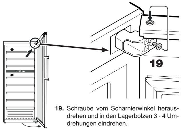
19. Schraube vom Scharnierwinkel herausdrehen und in den Lagerbolzen 3 - 4 Umdrehungen eindrehen.
