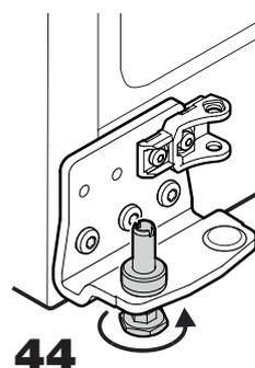
44. Bolzen vollständig in den Scharnierwinkel einsetzen und Stellfuß mit der Hand festziehen.
