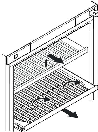
Für die Nutzung muss das darüber liegende Holzbord entnommen werden. Das Bord anheben und entnehmen.
