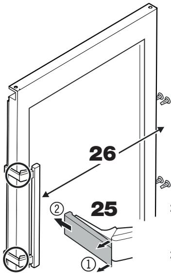
25. Druckplatten vorne austrasten ① und nach hinten abziehen ②.
