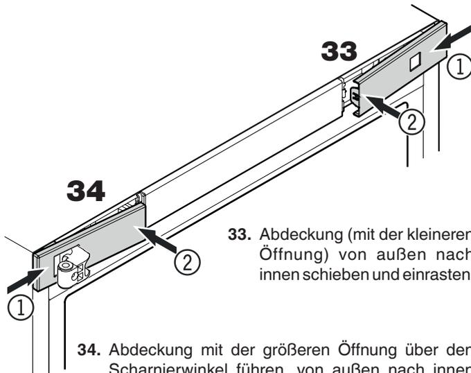
33. Abdeckung (mit der kleineren Öffnung) von außen nach innen schieben und einrasten.
