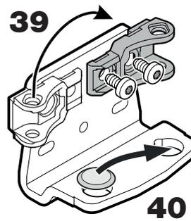
39. Die Halterung für Schließdämpfer am Scharnierwinkel umsetzen.
