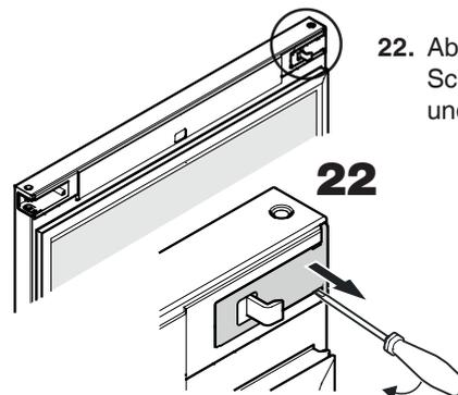
22. Abdeckung mit einem kleinen Schraubenzieher ausrasten und abnehmen.
