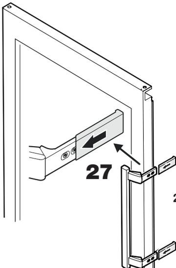
27. Druckplatten aufschieben, bis sie einrasten.
