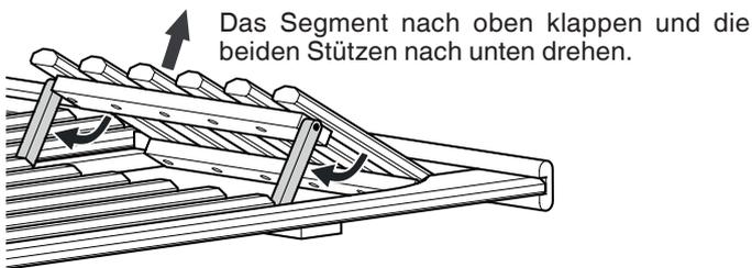
Das Segment nach oben klappen und die beiden Stützen nach unten drehen.
