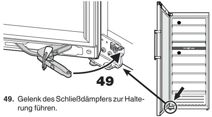
49. Gelenk des Schließdämpfers zur Halterung führen.
