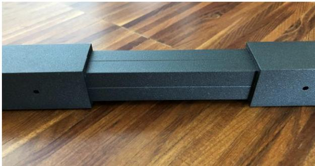
1. Die seitlichen Steher werden einseitig gebohrt (linker/rechter Steher am Rand) und zweiseitig gebohrt (Mittelsteher) geliefert. Verbinden Sie jeweils zwei oder mehr gleiche Steher mit den vormontierten Hülsen, indem Sie diese lose ineinander schieben.
