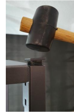
7. 4 Einsteckbuchsen einschlagen Montage der Flaschenauflage laut Folgesseite Xi Rack Anbau direkt an Basis anbauen Optionale LED Beleuchtung laut separater Anleitung nun anbringen
