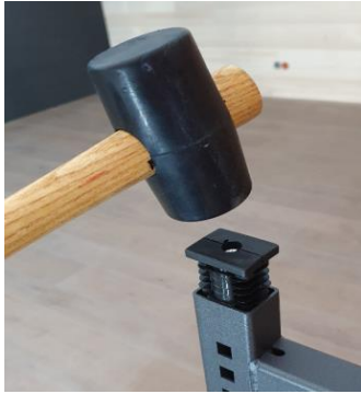
1. 4 FüÙe montieren 1. Mounting of 4 feet
