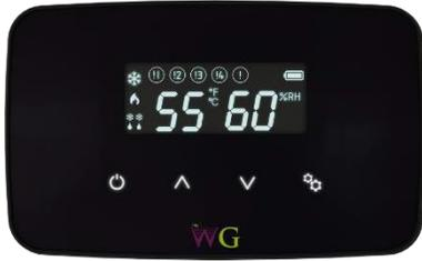
Die Wine Guardian Wireless2Base™ Schnittstellenfernsteuerung ist eine kombinierte Temperatur- und Feuchtigkeitssteuerung mit Steuerung von Kühlung, Heizen und Feuchtigkeit in einem Schritt. Ihr kapazitiver Touchscreen enthält einen Ein-/Aussschalter, Anpassungspfeile und Einstelltasten für einfache Verwendung und Programmierung. Zur Installation der Steuerung Es gibt zwei Möglichkeiten:
