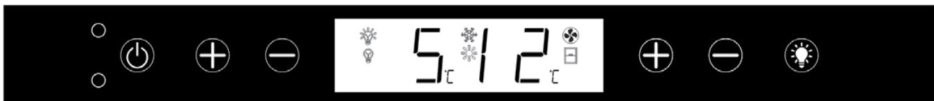
Für PM248D-HHB / PMW248D-HHB betragen die Minimal- und Maximaltemperatur 5-20 °C.
