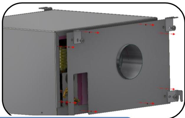
Schritt 1: Schrauben an der Frontverkleidung lösen und die Verkleidung abnehmen.
