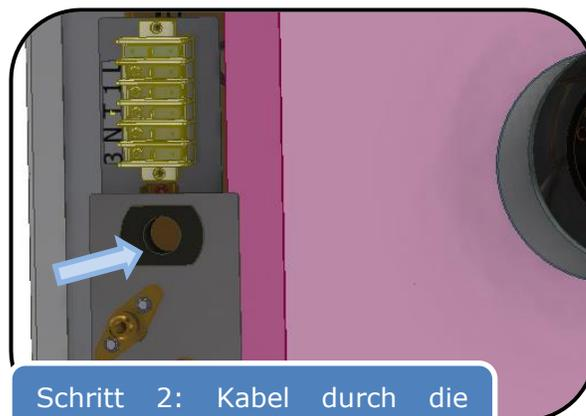
Schritt 2: Kabel durch die Stopfbuchse führen.
