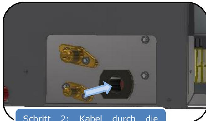
Schritt 2: Kabel durch die Stopfbuchse führen.
