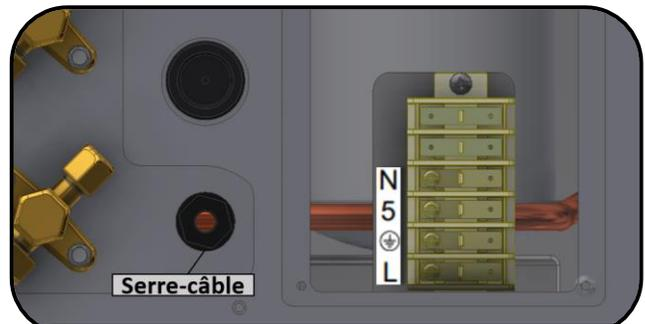
Schritt 2: Externe Einheit mithilfe des Kabels 4G1,5 (nicht im Lieferumfang enthalten) gemäß Anschlussplan (siehe Kapitel 3.5.4, S. 19) mit dem Anschlussgehäuse verbinden. Kabel durch die Stopfbuchse führen.
