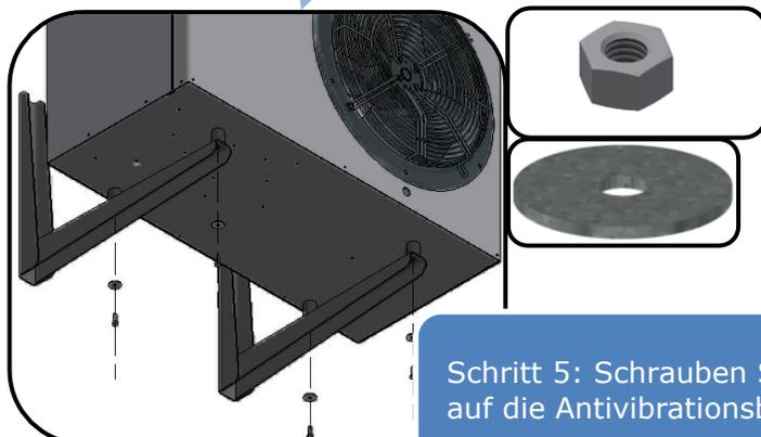
Schritt 5: Schrauben Sie die vier M8-Mutter-Unterlegscheiben-Baugruppen
