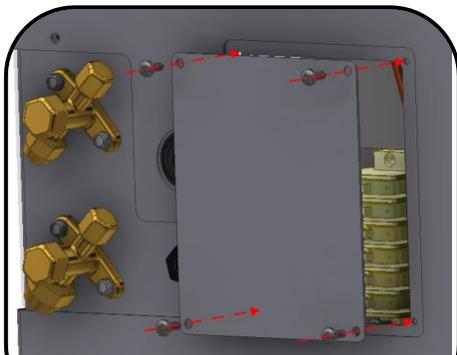
Schritt 1: Schrauben an der Abdeckplatte der elektrischen Anschlüsse an der externen Einheit lösen und die Platte abnehmen.
