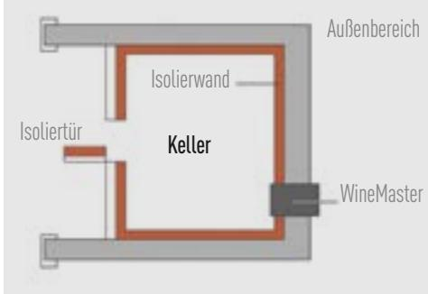
\* Mit einer an die Temperatur und das Volumen angepassten Isolierung
