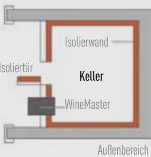
Klimaanlage, die in einer Wand installiert ist, die nach außen führt - Angepasste Modelle : **C25 SRX / C50 SRX**
