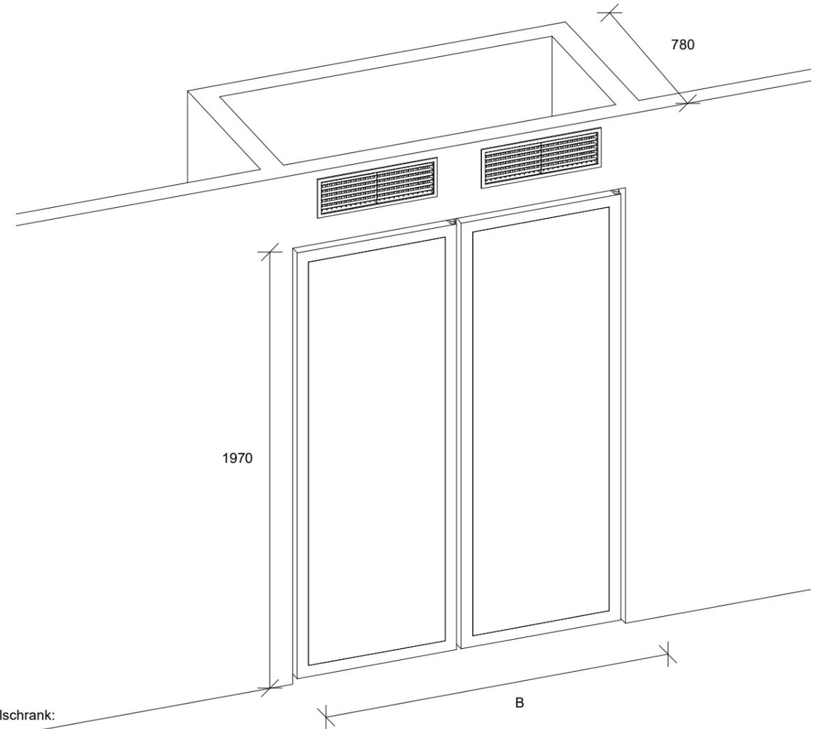
Zusätzliche Schalldämmung: Ausgeführt mit Ecophon Akusto Wand A - 40 mm. Wenn eine Schalldämpfung gewünscht wird, addieren Sie 40 mm zum Tiefenmaß hinzu. Als Ergänzung kann an den Seitenwänden eine Schalldämmung angebracht werden, auch hier gilt, dass zum Breitenmaß zusätzlich 40 mm hinzugerechnet werden auf jeder Seite (die Seiten dürfen nicht allein schallisoliert sein).
