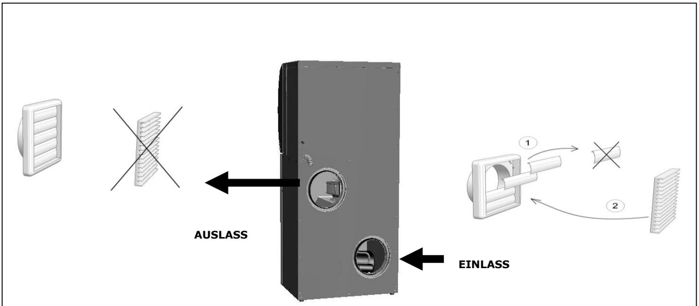
ACHTUNG! Jedes Gerät ist mit zwei Gehäusen ausgestattet (Auslass und Einlass). Den geeigneten Gitter-Typ anbauen.
